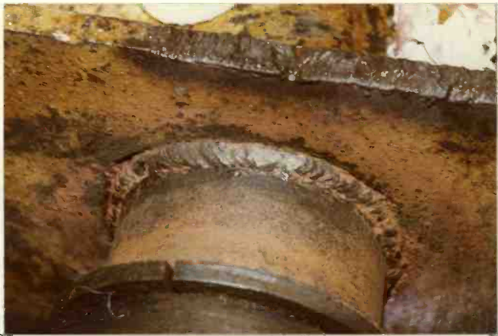
Foto IV. Verbindingslas van de roerkoning met het roer (zonder roestschillen).
